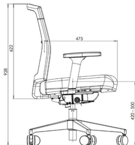
A Linha Snap atende as normas regulamentadoras NR17 e NBR13962, é considerada uma cadeira operacional do Tipo B, provida de dispositivo de regulagem :
